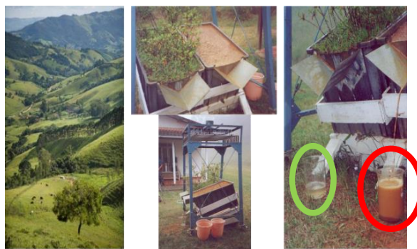
Figura 1: Simulação da infiltração da água no solo e o escoamento superficial em uma área florestada e outra com solo exposto.
