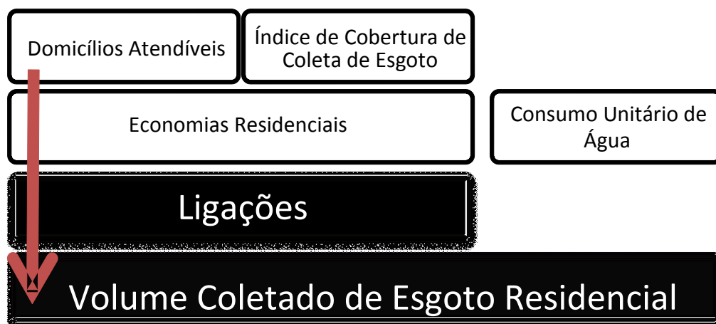
Figura 3.2- Lógica Geral de Cálculo para o Volume Coletado de Esgoto Residencial
