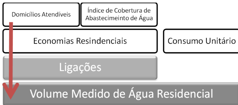
Figura 3.1 - Lógica Geral de Cálculo para o Volume Medido de Água Residencial
