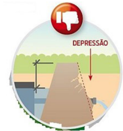
Figura 11. Trincas e Depressões
