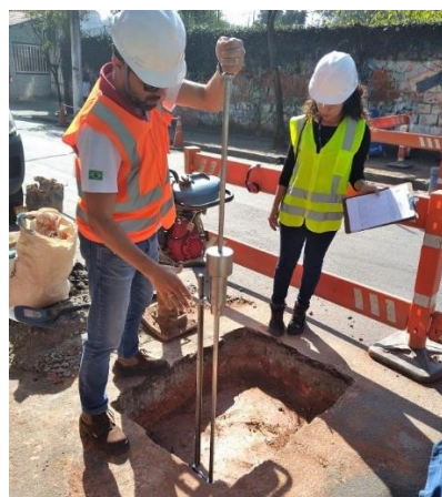
Figura 4 - Teste com Equipamento Penetrômetro Sul-Africano (DCP). (Fonte: Autor)
