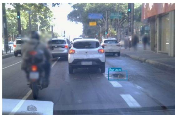
Figura 6 – Detecção de Buraco na via por I.A.
