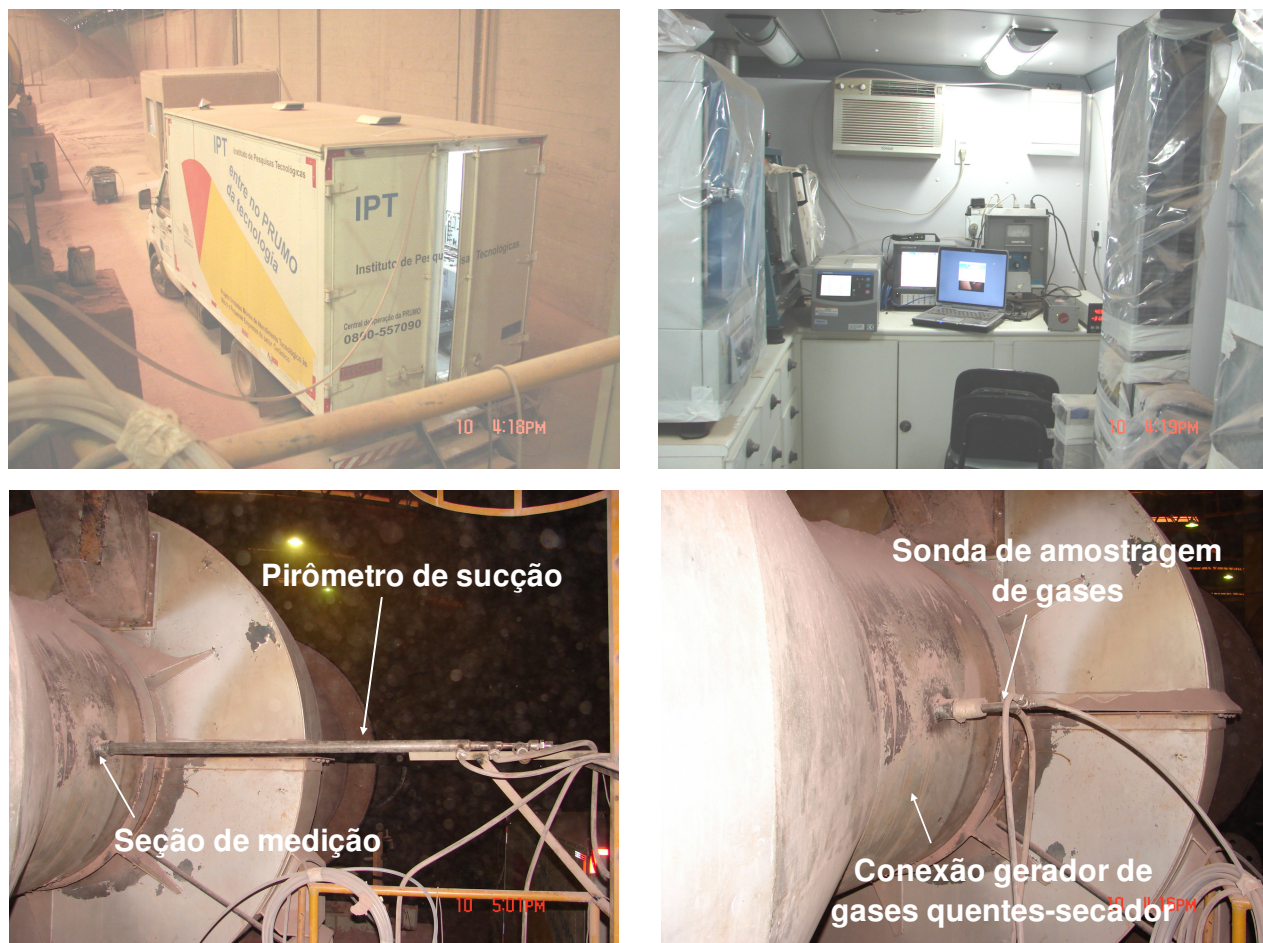
Figura 21 – Detalhes das medições de temperatura e composição dos gases na entrada do secador.
