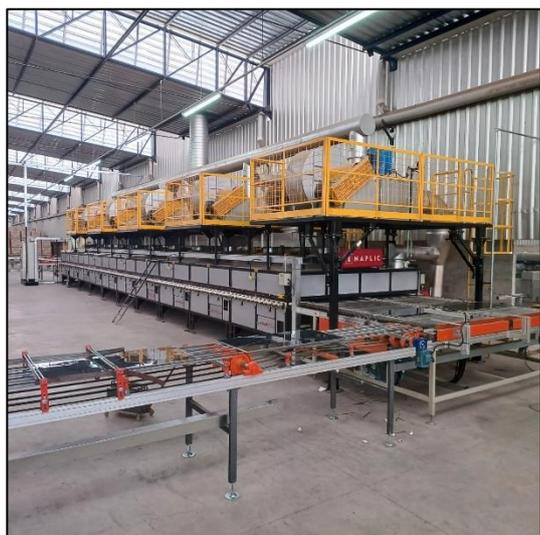
Figura 1. Secador de placas cerâmicas polidas operando.
