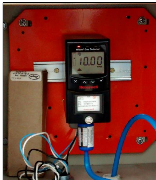
Figura 3. Sensor utilizado para detecção da concentração de fluoretos nos gases.
