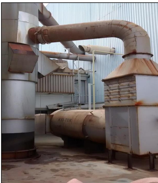
Figura 1. Vista do protótipo de abatimento de flúor instalado na empresa Ferro Enamel.
