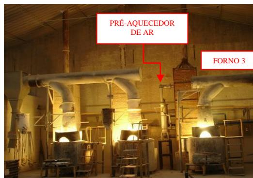
Figura 3 – Forno com pré-aquecedor instalado
