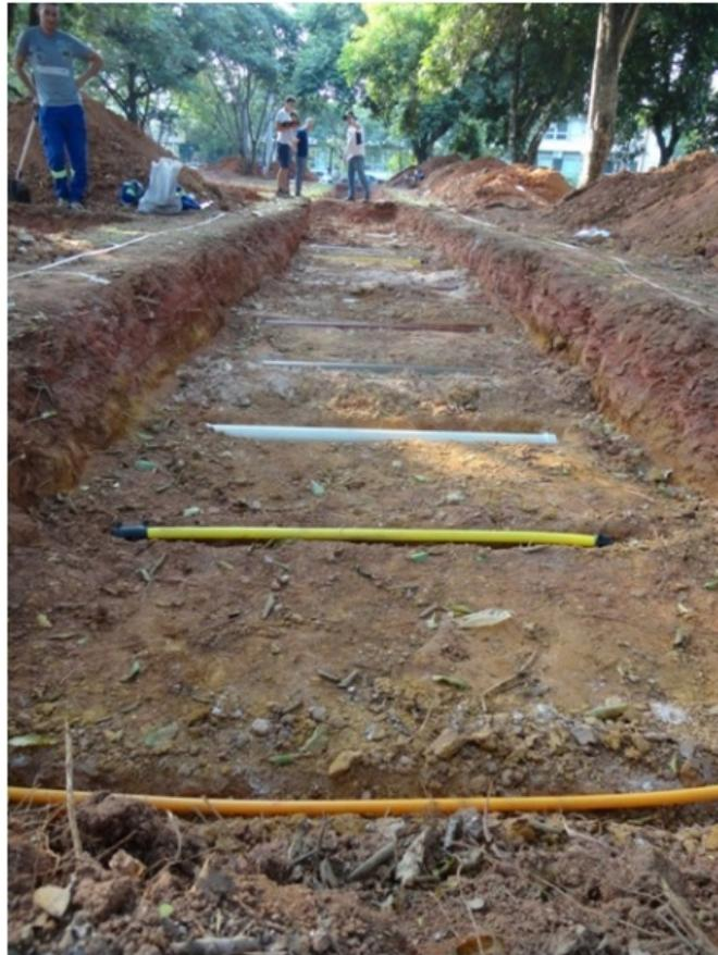
**Figura 2.** Diferentes tubulações instaladas na Linha 3 do SCGR-II do IAG/USP. Nesta vala os alvos estão instalados em 0,5m de profundidade.
