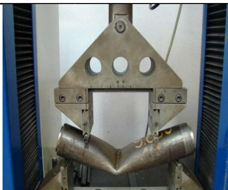
**Figura 1** – Imagem ilustrativa da configuração do ensaio de dobramento.
