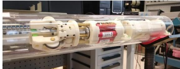
Figura 6 – Arranjo experimental para testes das primeiras versões do conjunto mecânico do ROV.
