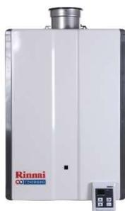
Basicamente os aquecedores tipo Condensing possuem um trocador de calor adicional que retira a energia dos gases quentes que seriam desperdiçados na chaminé, com isso a água entre no aparelho pré-aquecida. A temperatura esperada na chaminé após o aproveitamento do calor é de aproximadamente 50°C. O aparelho também possui embarcado uma automação superior que permite controles de proporcionalidade no aquecimento de água mais adequado, permitindo inclusive, um acionamento em
