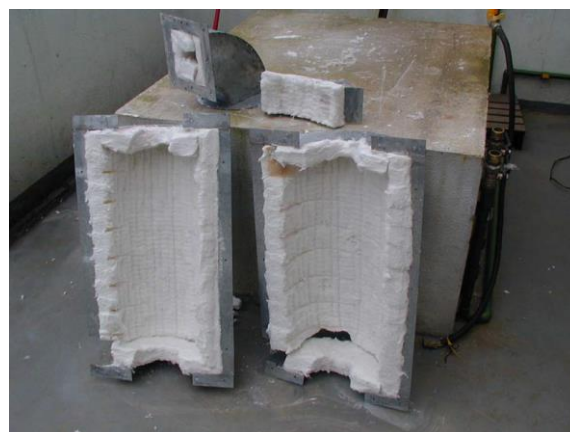
Figura 1 – Câmara de aquecimento
