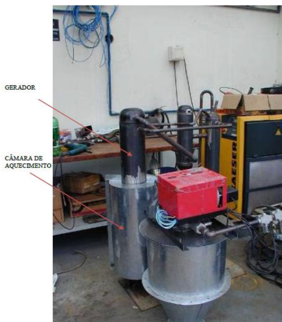
Figura 3 – Visão geral do equipamento construído com o queimador montado
