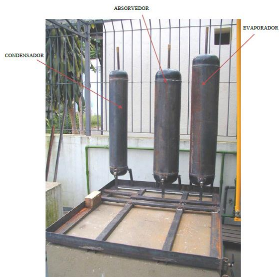
Figura 2 – Condensador, absorvedor e evaporador construídos
